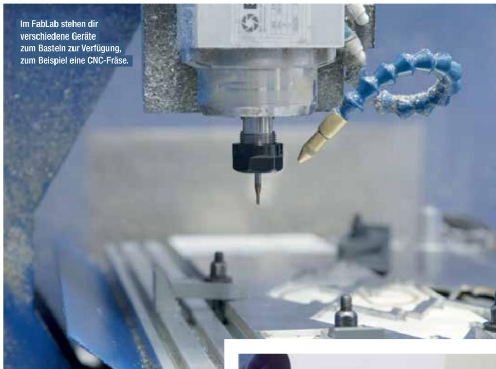
Im FabLab stehen dir verschiedene Geräte zum Basteln zur Verfügung, zum Beispiel eine CNC-Fräse.
